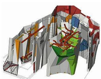
Für den Kletterbereich wurde ein Konzept mit hybrider Lüftung entwickelt. Für die Wärmeversorgung sorgt eine Holzhackschnitzelanlage
