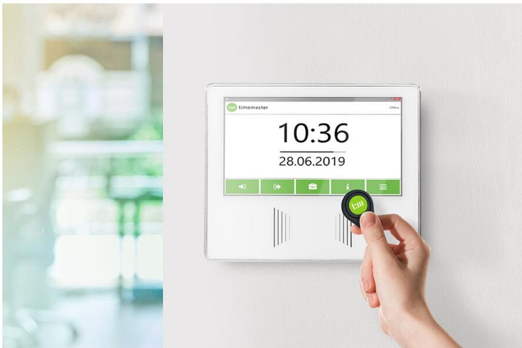
Über ein modernes, einfach bedienbares Terminal können Arbeitszeiten mithilfe handlicher Funk-Transponder schnell und kontaktlos erfasst werden
